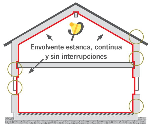
Fig. 8: La envolvente estanca al aire debe planificarse previamente en todos los puntos críticos. Los sistemas de fabricantes diferentes no deben combinarse [www.passiv.de]
